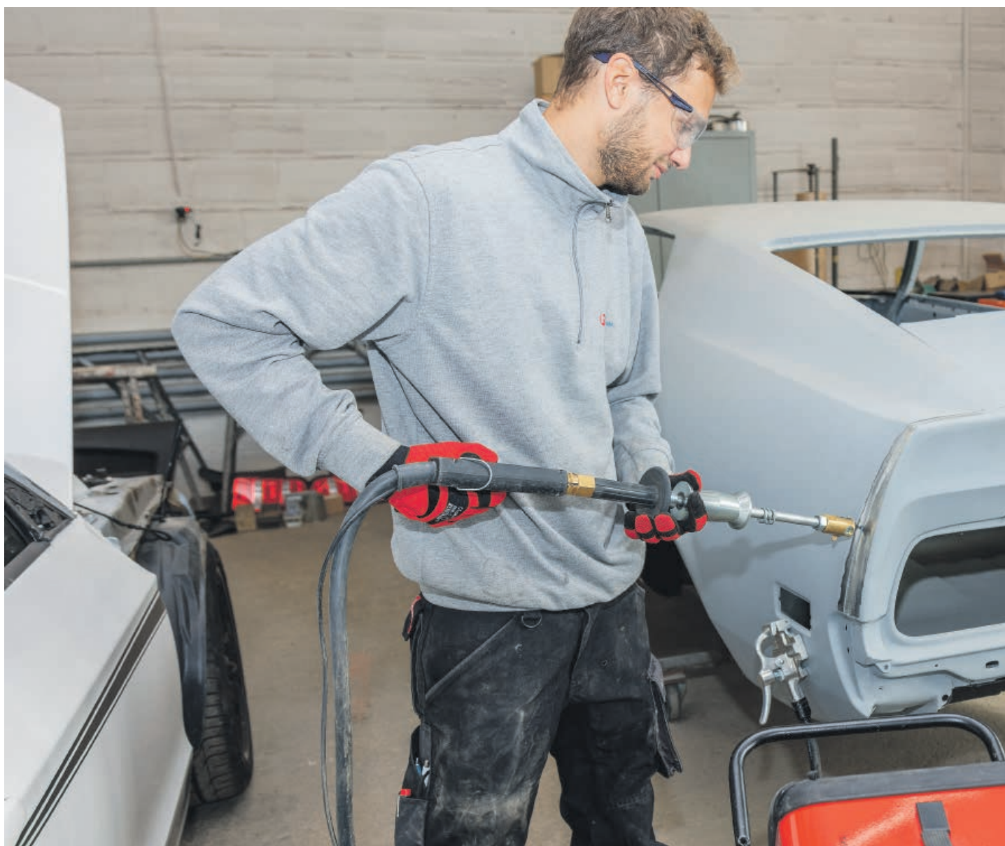
Daniel Huser alle prese con la raddrizzatura della fiancata di una Ford Mustang Boss del 71.
