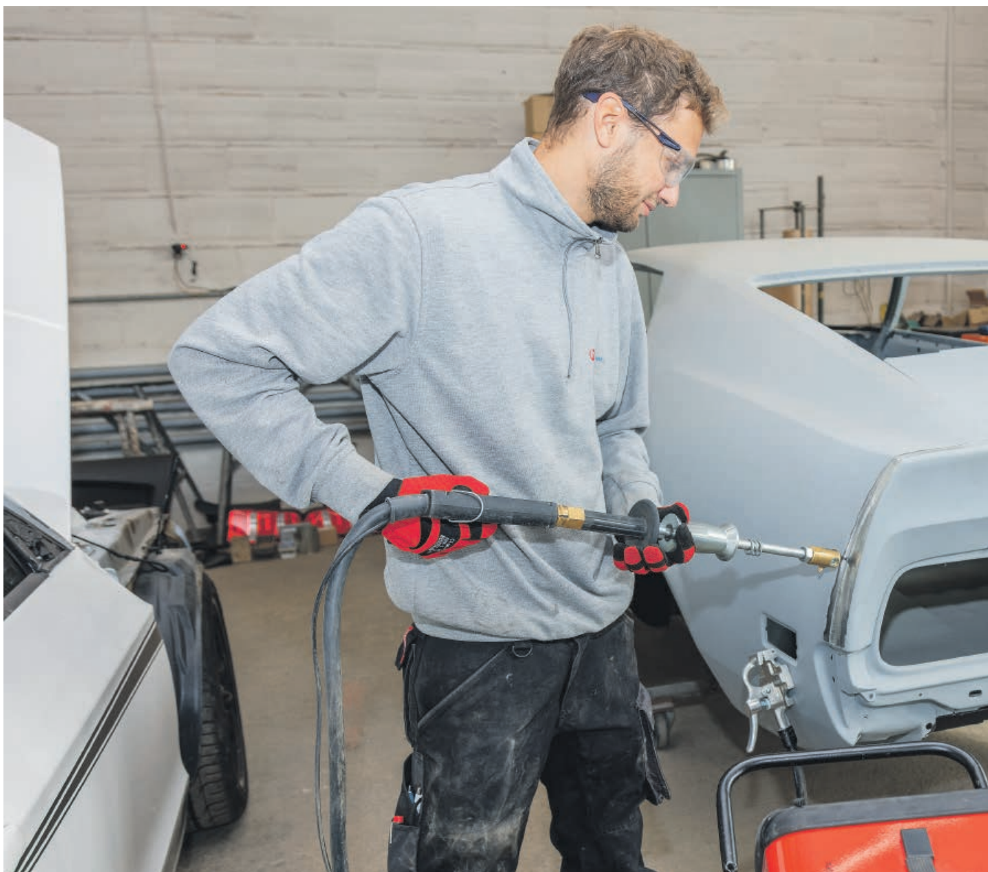
Daniel Huser beim Ausbeulen einer Seitenwand eines Ford Mustang Boss, Jg. 1971.
