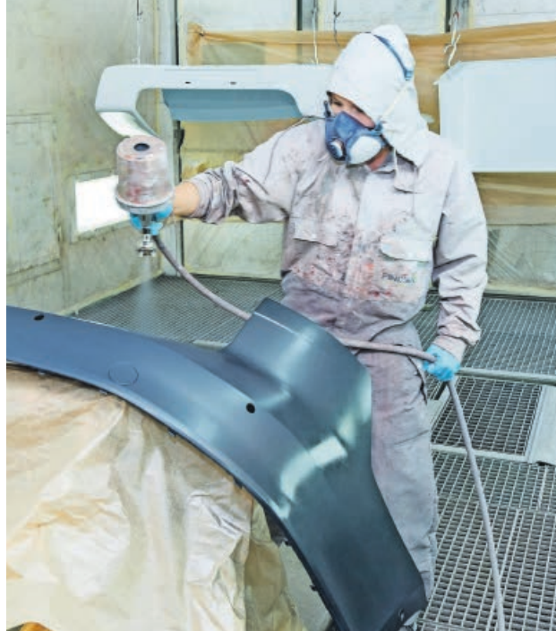
Professionelle Lackierarbeiten – hier das Lackieren einer abgebauten Stossstange – sind ein wichtiger Teil des Angebots.
