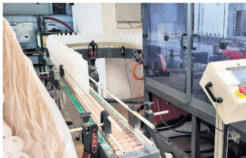
Abfüllen mit Linien-Abfüllmaschine von rohrvit Gel.
