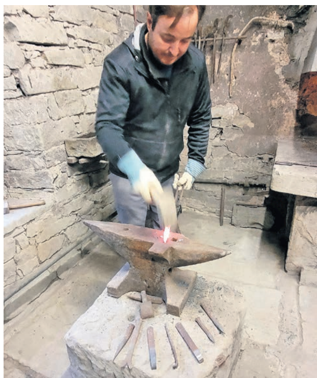
Les burins émoussés sont reforgés dans la propre forge de la carrière.
