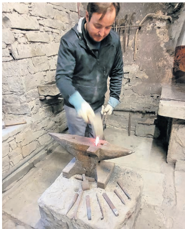
Stumpfe Meissel werden im Steinbruch nachgeschmiedet.
