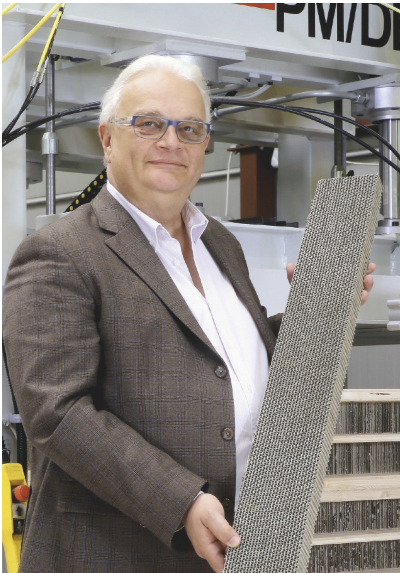
Fredy Iseli mit Waben aus mineralisch beschichteter Wellpappe. Mit Holzplatten beplankt (Hintergrund) wird das Altpapier zu einem feuerhemmenden, wasserabweisenden, wärmedämmenden und hoch belastbaren Wand-, Decken- oder Dachelement.
