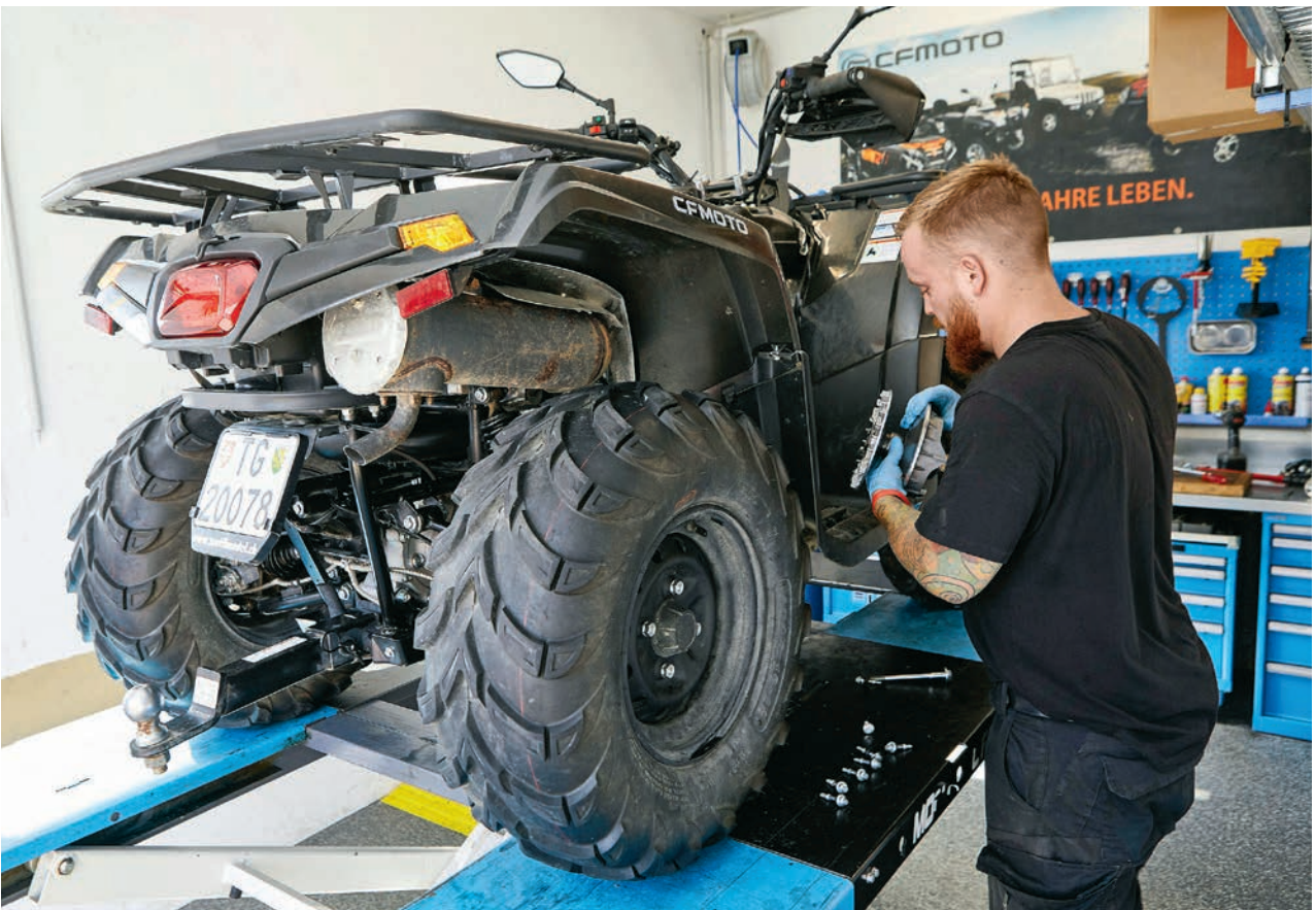
KSR Swiss beschäftigt 13 Mitarbeitende. In der Werkstatt in Happerswil repariert Motorrad-Mechaniker Bedja Tschudi das Automatikgetriebe eines Quad.
