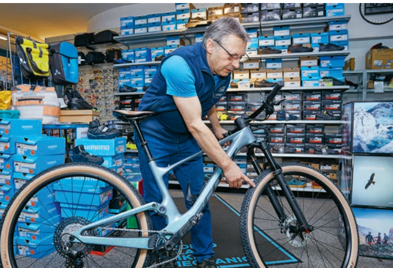
Weniger Gewicht, weniger Rollwiderstand und weniger Pannen: Schlauchlose Reifen sind mit einer Flüssigkeit gefüllt, die Löcher sofort abdichtet.
