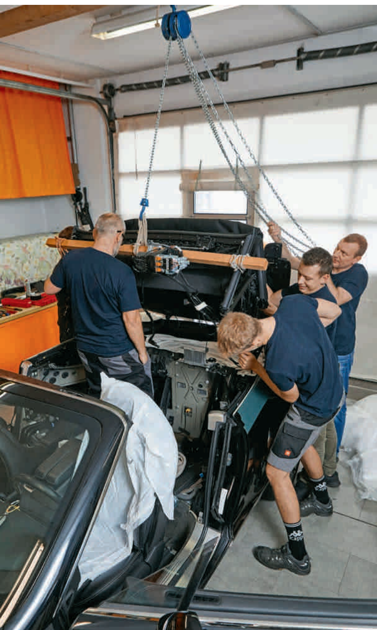
Die komplette Verdeckeinheit eines Bentley-Cabrio wird von den Mitarbeitern der Autosattlerei Kress ausgewechselt.
