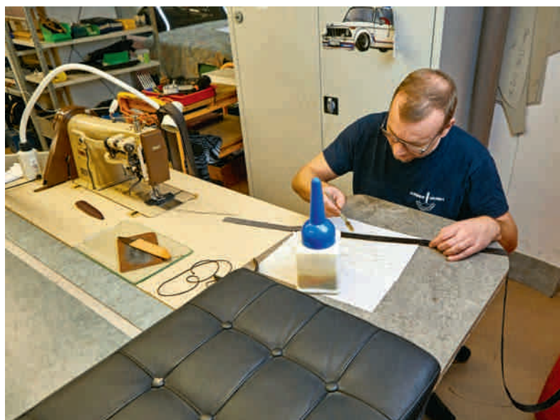
Ein Mitarbeiter verfertigt Keder, eine Randverstärkung aus Leder, für den Neubezug des De-Sede-Sessels (Sitzpolster im Vordergrund).
