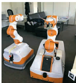
3-D-Druckteile für den Roboter Lio der Firma F&P Personal Robotics. Die Kress GmbH polstert sie mit Schaumstoff und bezieht sie mit Kunstleder. Die Polsterung ist wichtig, da sich die Roboter zwischen Menschen bewegen – z. B. in Altersheimen oder Spitälern, um Getränke und Mahlzeiten in die Zimmer zu bringen.
