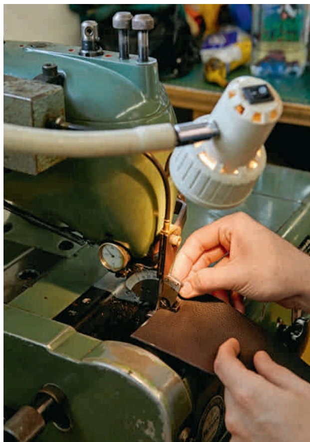
Bearbeitung der Kanten von Lederstücken für den Neubezug eines De-Sede-Sessels.
