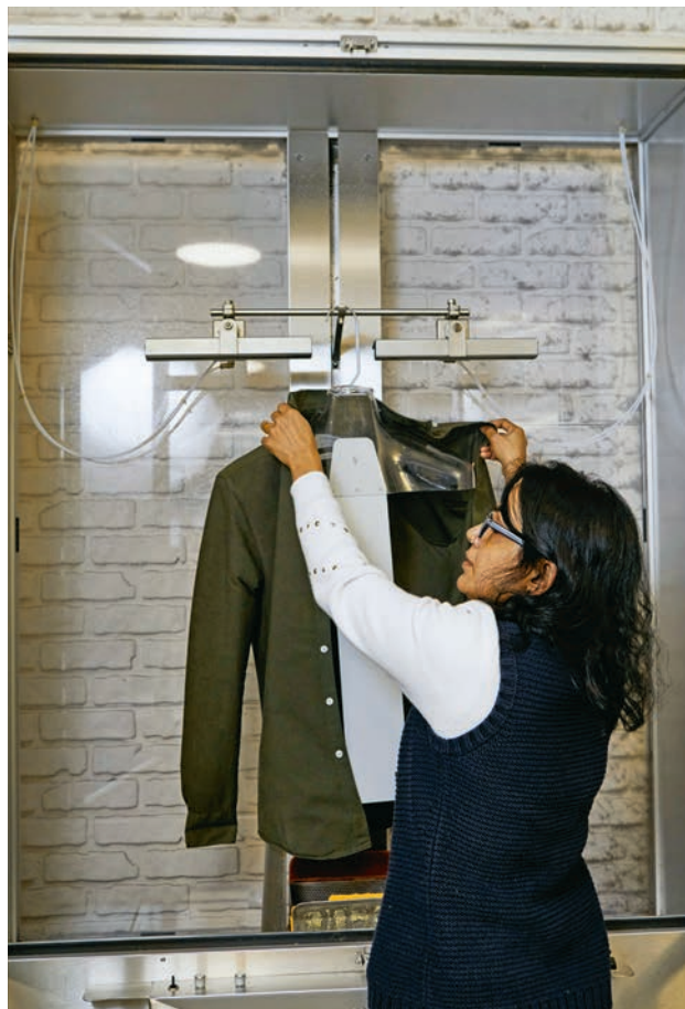
Auch ein Dampfbügelschrank kommt zum Einsatz.
